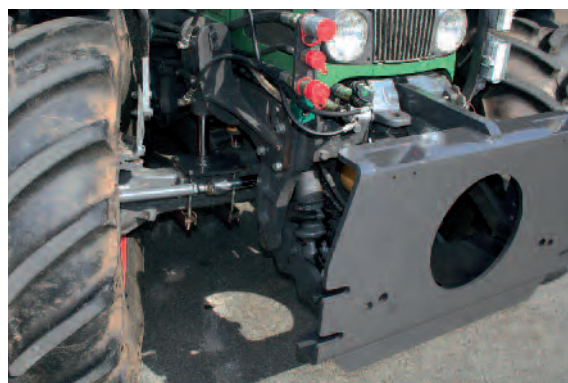
Frontplade med hydraulisk akselstøtte
