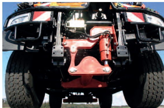
Hydraulisk torsionsramme på Unimog
