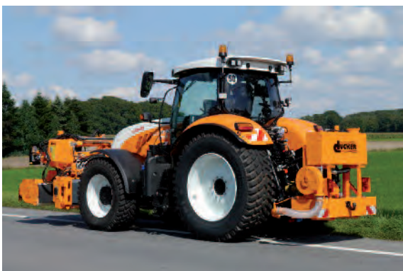
Klippekombination MK i delt konstruktion (hydraulikaggregat i bagmontering) på Steyr-traktor
