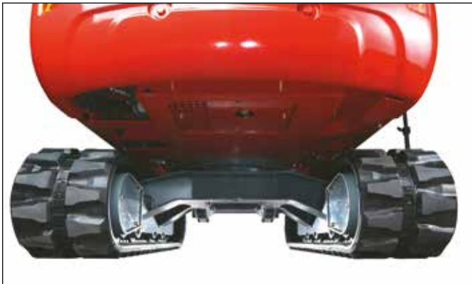
Gran distancia del eje hasta el suelo, cárter del motor cerrado y protegido.
