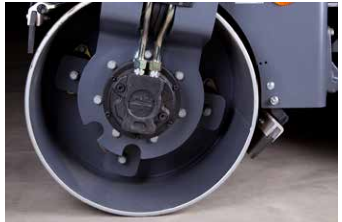
Dank des großen Bandendurchmessers ist die Verdichtung selbst auf weichen, schwierigen Asphaltmischungen einfach. Die dicke Bandenummantelung garantiert eine lange Lebensdauer.
