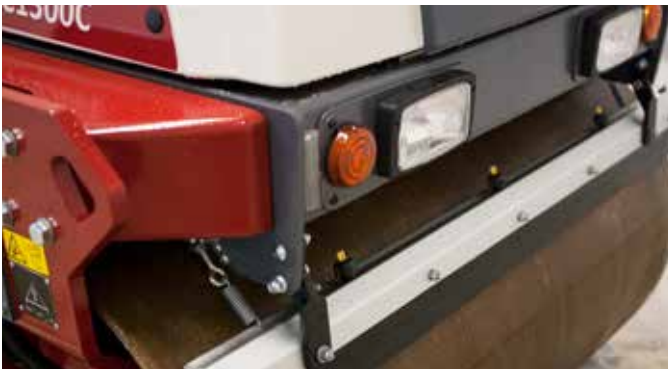
Druckberieselungssystem mit leistungsstarker Wasserpumpe und selbstentleerenden Schläuchen und Düsen.
