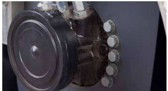
Die ausfallsicheren Bremsen an beiden Bandagen (Kombirädern) reagieren automatisch bei Störungen des Motors, des Hydraulik- system oder der Bremselektrik.
