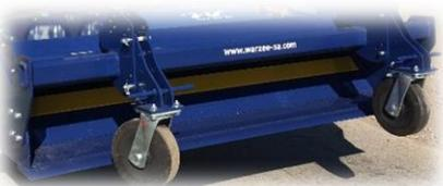
Le bac récolteur est équipé d'une **lame de raclage** qui permet de décrocher et récolter les gros éléments.
