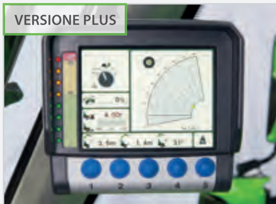
Sistema M CDC con display e riconoscimento automatico dell'attrezzatura
