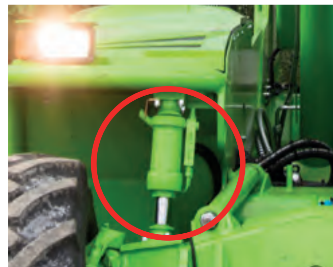
Sistema Tilting per la correzione dell'inclinazione
