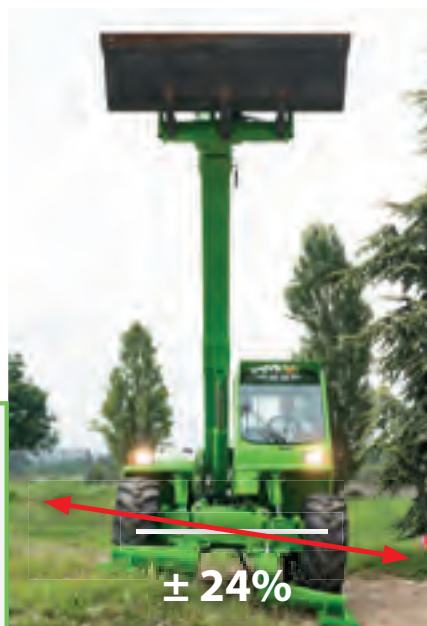
L'azione combinata dell'inclinazione laterale e degli stabilizzatori
