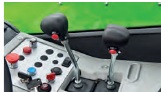
Versione 75 HP: leve per azionamento braccio, zattera, attrezzi e traslazione laterale del braccio
