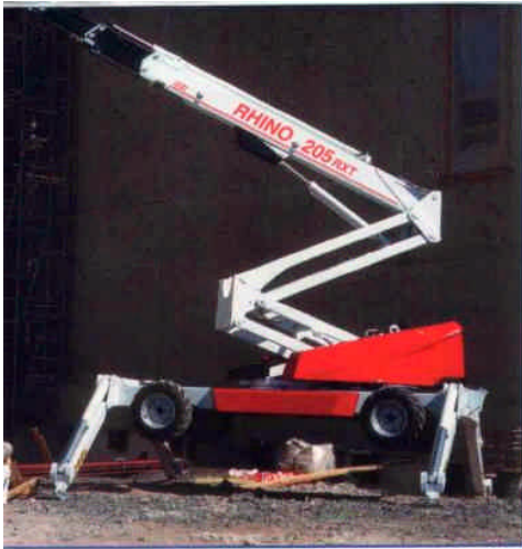
Scherengelenk mit einer senkrechten Bewegung von 3,3 Metern
