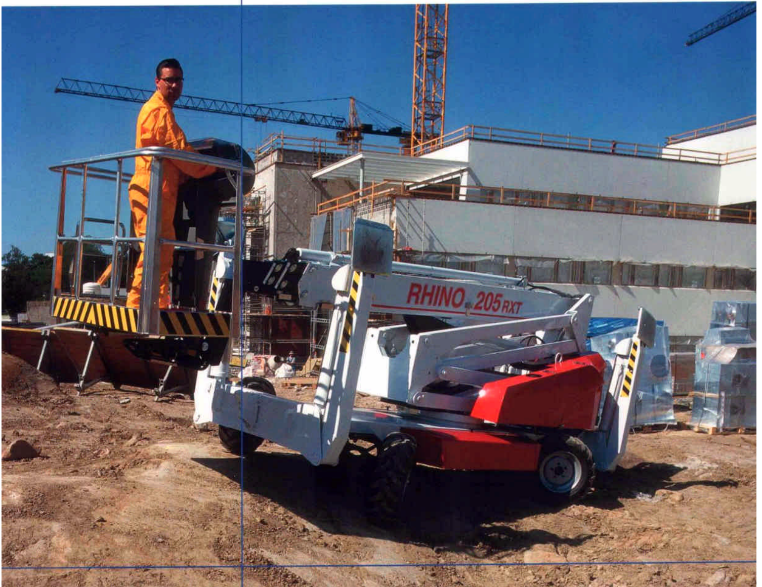
Optimaler Einsatz dank der Pendelachse auch in schwerem Gelände
