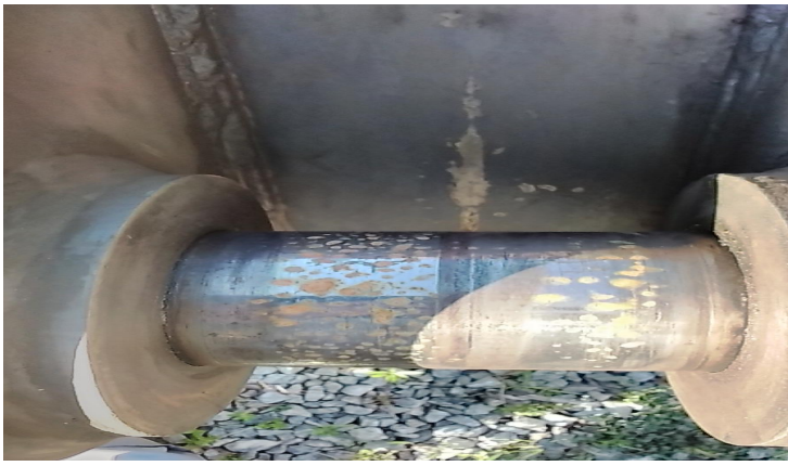
pino lado haste do braço danificado
