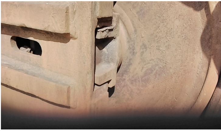
desgaste acentuado no material rodante
