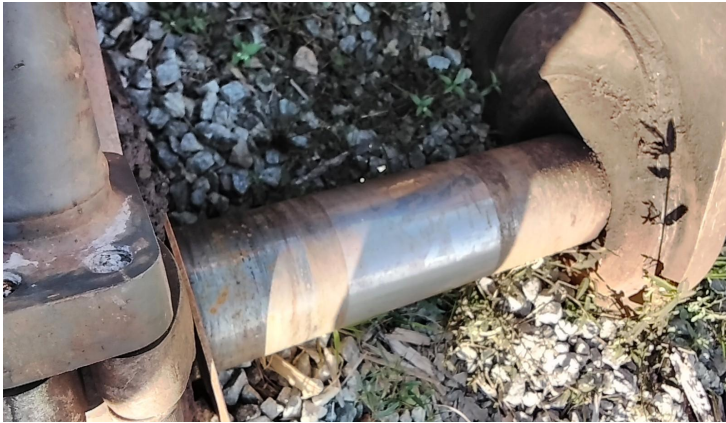
pino de junção da lança com braço danificado
