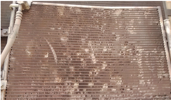
condensador obstruído necessria substituição
