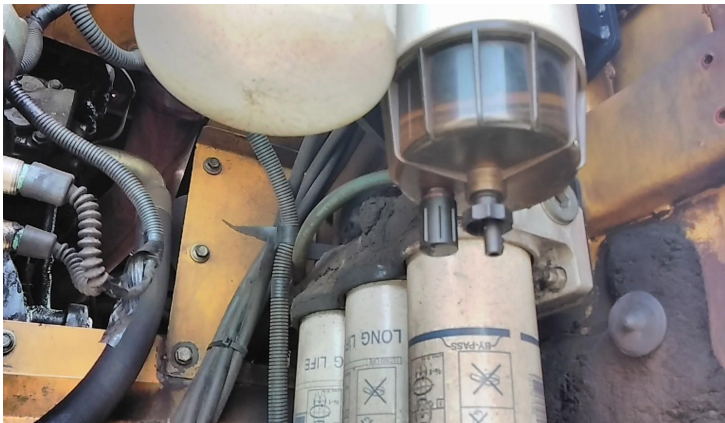
sensor do filtro separador de água danificado
