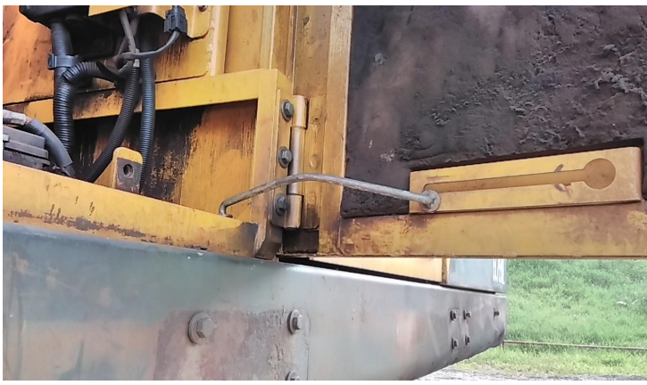
trava da tampa da caixa de baterias empenada
