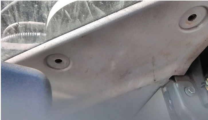
várias presilhas de carenagem interna da cabine faltantes
