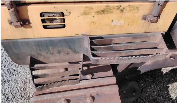
escadas de acesso ao carro superior substituídas por modelos não original
