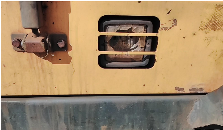
farol frontal lado esquerdo danificado
