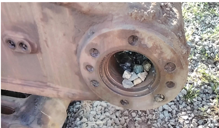
placa de desgaste do pino da caçamba danificado
