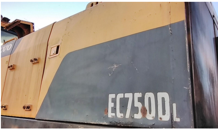
tampa lateral compartimento das Bombas danificada
