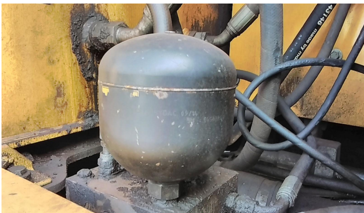
acumulador servo danificado
