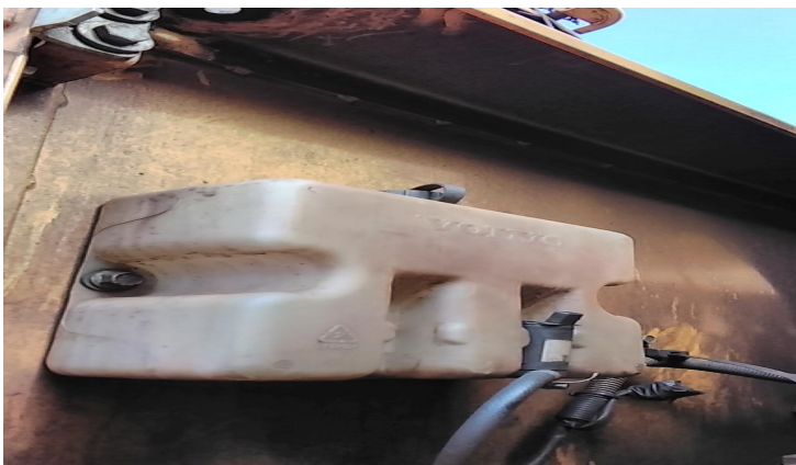
bomba do lavador do para-brisa danificado
