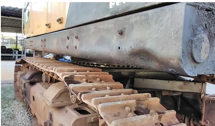
longarina do chassi superior esquerda danificada
