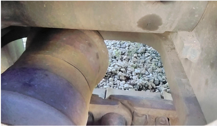
quarto rolete inferior lado esquerdo danificada
