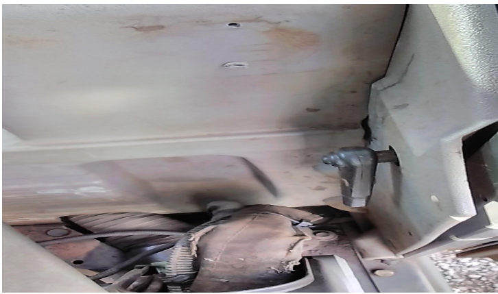
trava da porta da cabine danificada
