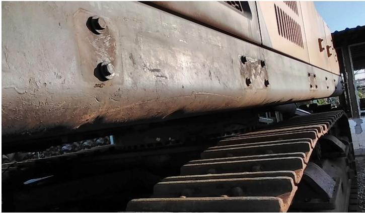
pequenos amassados na longarinas do chassi superior lado direito
