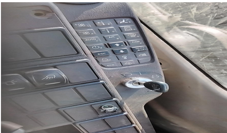
balancim da tecla faltante e chave de partida não original
