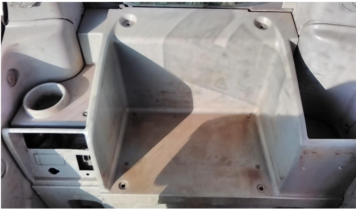
falta parafuso de fixação da carenagem e borracha de acabamento
