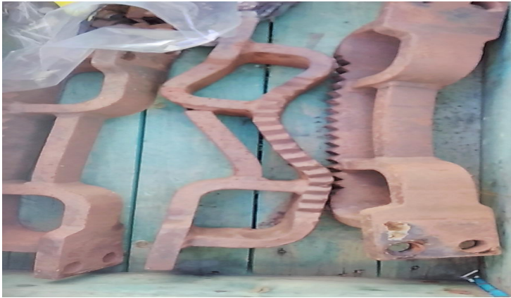
escada inferior do chassi inferior danificada
